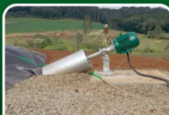
SISTEMA DE AGITAÇÃO PARA BIODIGESTOR E LAGOAS
